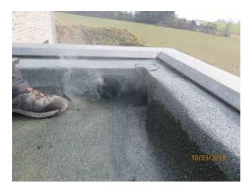
Für den Rauchtest ist es zwingend erforderlich, dass die Brandmeldeanlage partiell für den Zeitraum der Untersuchung (ca. 2 Stunden) ausgeschaltet wird, sodass es zu keiner Fehlalarmierung der örtlichen Feuerwehr kommt.
