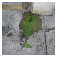
Das in Wasser gelöste Uranin-Pulver macht die Farblösung bereits ohne technische Hilfsmittel sehr gut sichtbar.
